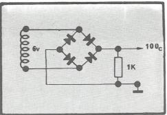
será incorrecta, marcando el voltimetro: 1,4...., en este caso basta con retrasarle un paso atrás,para que añadiendo el número de ceros correspondientes a ese paso nos dé la frecuencia introducida. En el caso de no tener un generador de frecuencias, podemos ingresar la señal de 100 cs /s procedente de un transformador de 6 ó 12 V con un rectificador puente (Fig. 4) y una resistencia.
