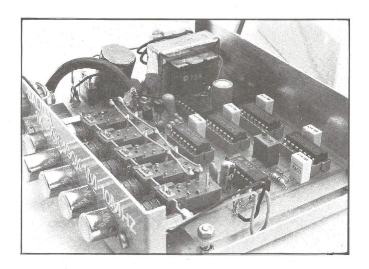
El medidor de frecuencias que vamos a presentar aqui, no pretende compararse a los frecuenciómetros digitales clásicos con seis y ocho cifras, dado sus precios elevados, si no mas bien, cubrir ese espacio que hay en el laboratorio cuan-do tenemos que ajustar circuitos digitales de BF, de tipo Kit o montajes caseros.
