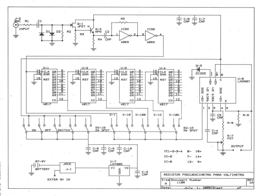
periores a 50V, que es el máximo admisible, la ressitencia de IM2 unida a las caracteristicas intrínsecas del BF 256, nos proporciona la entrada en alta impedancia.
